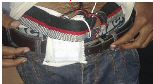
Dos baterías de 9 voltios en un bolso, atado a otro cinturón, cables dirigidos en ambas direcciones.
